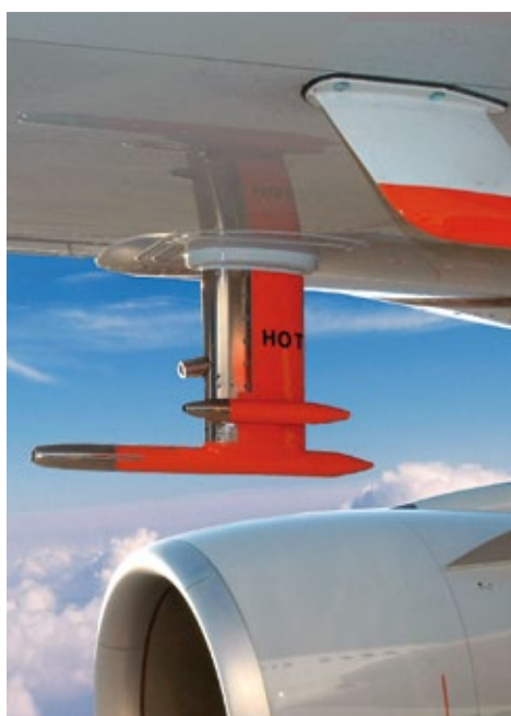
LAGOS-CARIBIC A340-600 der Lufthansa mit Lufteinlass-System (links) und 1.6 t schweren Labor (rechts unten), das für vier Flüge pro Monat im Frachtraum eingebaut wird und automatisch Messungen durchführt. (Fotos: Kröner/Lufthansa AG (links), Lufthansa AG (rechts oben), MPI für Chemie (rechts unten))
