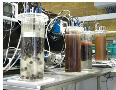
Die vier Laborreaktoren, an denen die Deammonifikation untersucht wurde. (Foto: Susanne Lackner, KIT)
