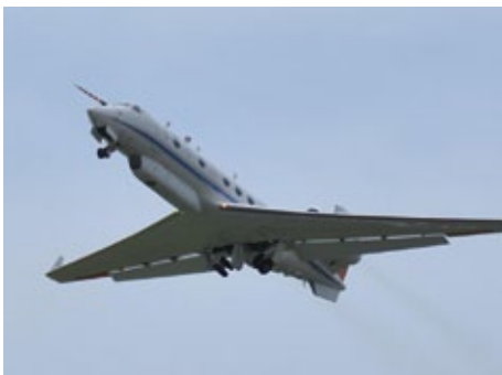
Vom Rumpf des Flugzeuges aus misst das Infrarot-Spektrometer GLORIA Spurengase in der Atmosphäre. (Foto: IMK)
