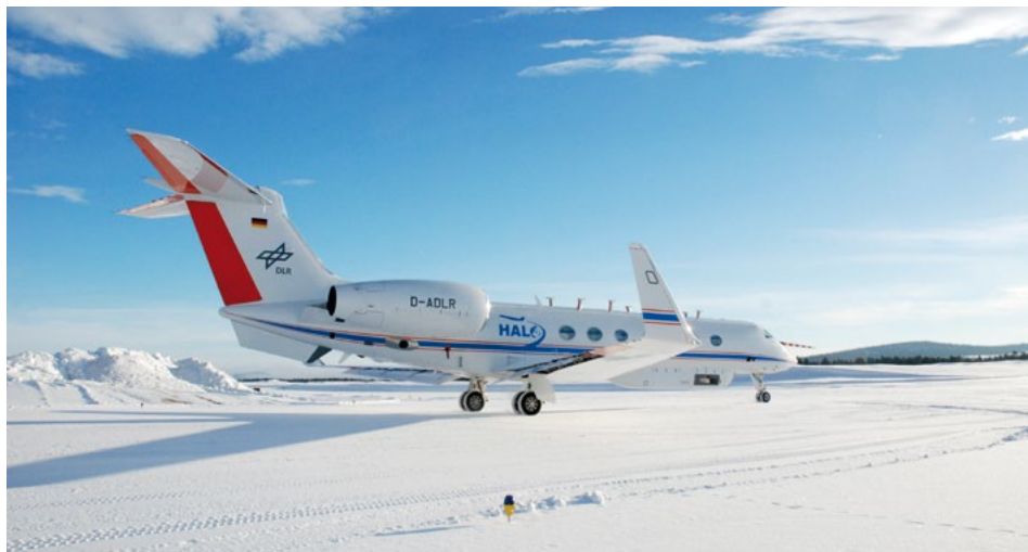
HALO in Kiruna vor dem Start. Auf der Oberseite des Rumpfes sieht man eine Reihe von Lufteinlässen für die in situ Messgeräte, an der Unterseite das GLORIA Infrarot-Spektrometer. (Foto: Björn-Martin Sinnhuber)
