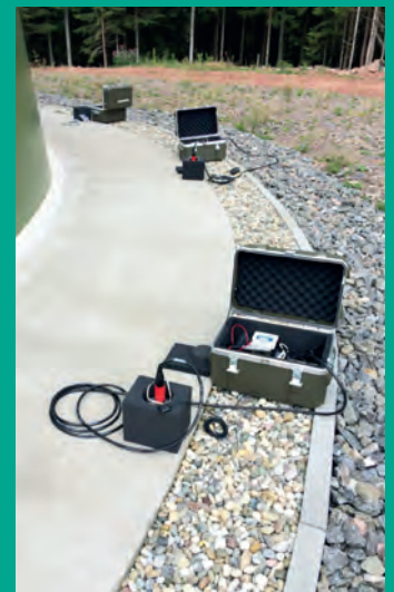
Messung der Bodenbewegung mit mobilen Erdbeben-Messstationen auf dem Fundament einer Windenergieanlage. (Foto: KIT-GPI)
