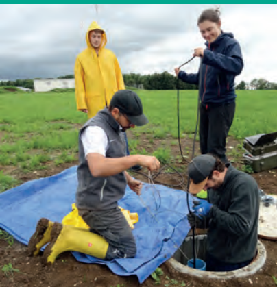
Installation eines Bohrlochseismometers am WINSENT-Testfeld bei Stötten auf der Schwäbischen Alb. (Foto: KIT-GPI)
