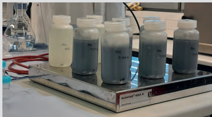
Proben in Reaktionsgefäßen auf einer Heiz-Rührplatte. Hier werden Experimente zur Desorption von Lithium von Lithiumeisenphosphat mit unterschiedlichen Lösungen unterschiedlicher Konzentrationen gemacht. Die klaren Gefäße sind sogenannte Blanks, Experimente ohne Lithiumeisenphosphat, die der Qualitätskontrolle dienen. (Foto: R. Reich, KIT)
