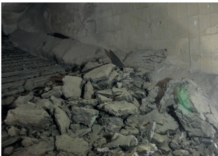
*Wenn es zu spät ist: Schlacke und abgelöste Beläge aus einem Biomasseofen – ein Fall für die Entsorgung. (Foto: Kolb / KIT)*
