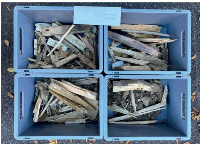
*Brennstoffvielfalt im Versuch: Biogene Abfallmischungen, die am KIT auf ihr Anbackungspotenzial untersucht werden. (Foto: Kolb / KIT)*
