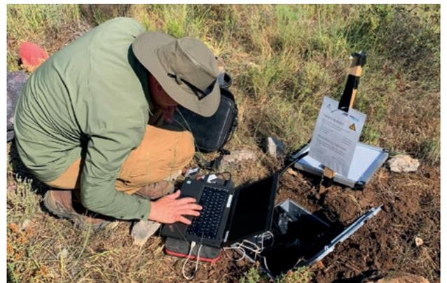
Installation eines seismischen Sensors: Das Team misst feinste Erschütterungen rund um den Vulkan Methana. (Foto: Jan-Phillip Föst)
