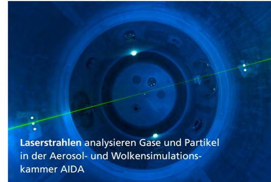
Laserstrahlen analysieren Gase und Partikel in der Aerosol- und Wolkensimulationskammer AIDA
