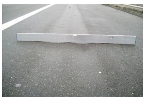
Bei heißem Wetter und unter hoher Belastung, zum Beispiel durch Schwerverkehr, verformt sich der Asphalt, Spurrinnen entstehen. (Foto: KIT/ISE)
