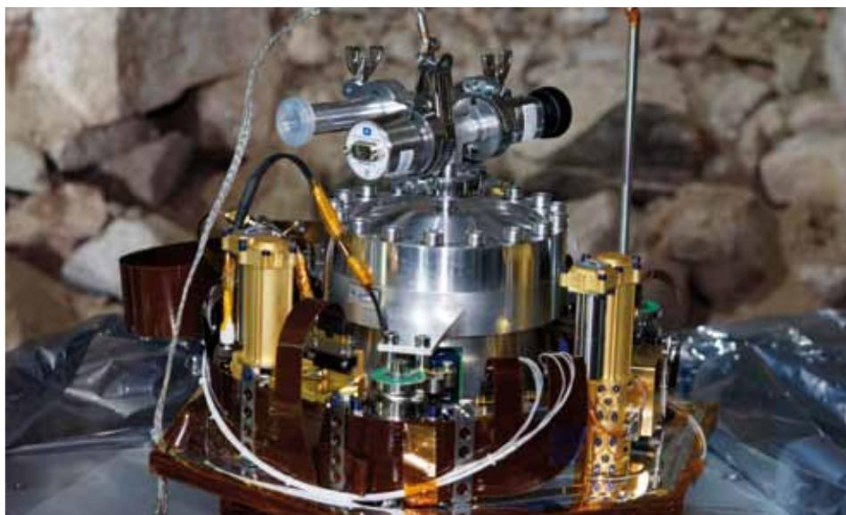
Im BFO-Stollen getestetes Marsseismometer: Die Vakuumkammer mit den Sensoren ist zwischen drei motorisierten Fußschrauben positioniert (nur zwei sind sichtbar). Mit Letzteren wird das Seismometer horizontaliert. (Foto: Philippe Labrot, IGP, Paris)
